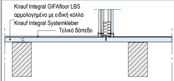
F191-V14 GIFAfloor LBS σε ξύλινες δοκούς, Knauf W111 (κλίμακα 1:10)
