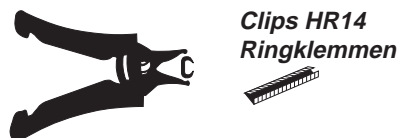
3 Overlappingsen De overlappingsen moeten zorgvuldig met ringklemmen of binddraad om de 20 cm aan elkaar verbonden worden. Zo voorkomt men verschuivingen.
