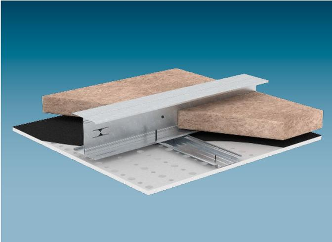
Cleaneo Classic Platten werden auf eine Metall-Unterkonstruktion aus freitragenden Grundprofilen aus Einfach- oder Doppelprofilen CW bzw. UA sowie Tragprofilen aus Hutprofilen geschraubt. Die Befestigung der Grundprofile erfolgt ausschließlich an den flankierenden Wänden. Zwischen den Grundprofilen (auf den Tragprofilen) kann eine akustisch wirksame Dämmschicht aufgelegt werden.
