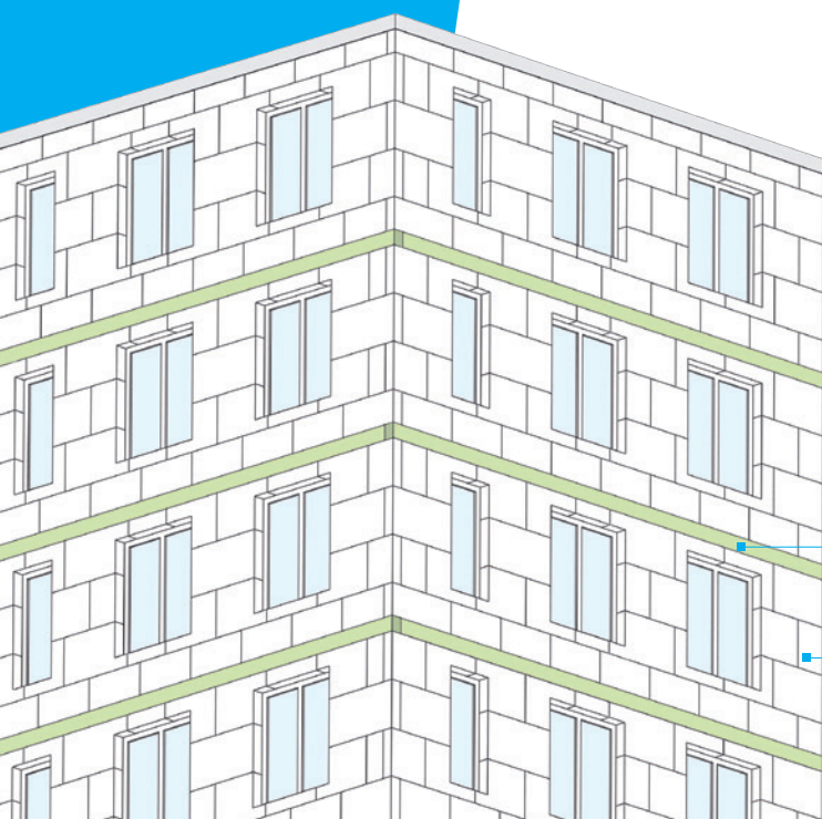
Umlaufende Brandschutzbänderole in jedem Geschoss
