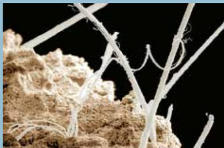
Die Bindemittelmatrix des Knauf SM700 Pro bietet hohe Sicherheit durch ausgereifte Fasertechnologie.
