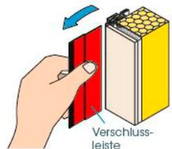
3. PUR-Fugendichtband expandiert und verschließt somit das Fensteranschlussprofil schlagregendicht.
