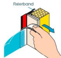
2. Abschließend rote Verschlussleiste seitlich herausziehen: PUR-Fugendichtband kann expandieren.
