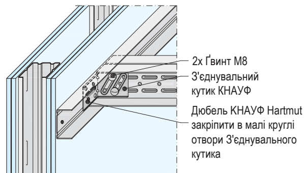
Примикання до перегородки на металевому каркасі з кріпильною траверсою
