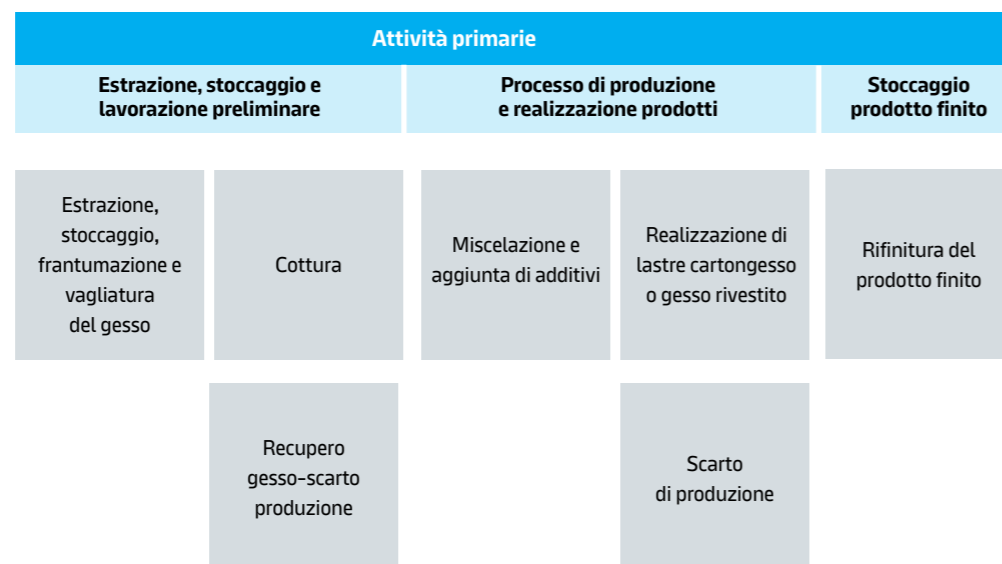
Figura 2: Processo produttivo per la realizzazione di lastre (stabilimento di Castellina)
