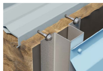
Cas d'une ossature secondaire de type « Oméga »
