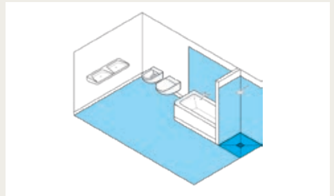
Häusliches Bad mit Badewanne ohne Brause und mit bodengleicher Dusche mit Duschtrennung
