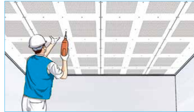
3 300mm 간격내로 나사못을 이용하여 M-바에 아트 사운드를 고정합니다.
