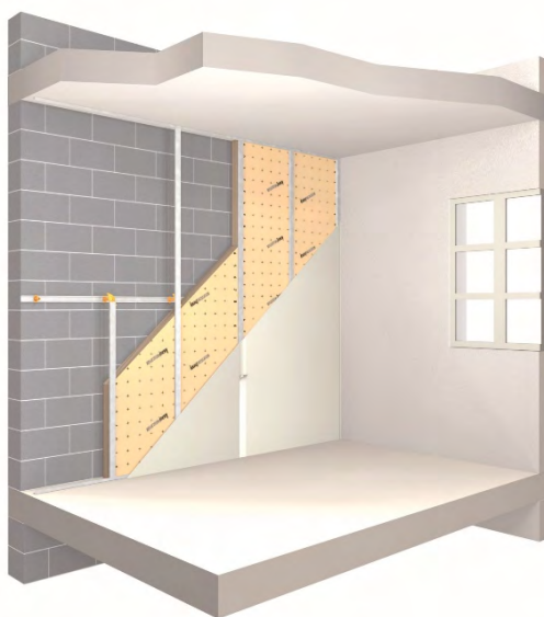
Imagen 2. Instalación sobre perfiles metálicos en horizontal
