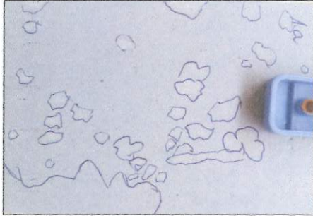
Hình ảnh hai mặt của mẫu thử sau khi phơi nhiễm nấm 21 ngày (Two-sided image of test samples after 21 days of exposure)
