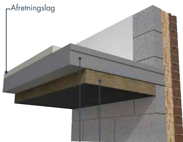
Afretningslag Eksisterende betondæk Soffit Linerboard
