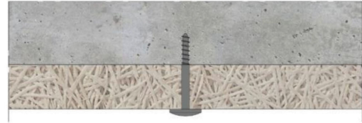
Organic vissage sur béton Partie courante
