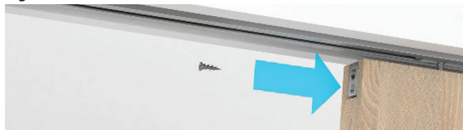
Fig. 9 : Visser l'étrier et le rail avec une vis 4 x 18 mm.
