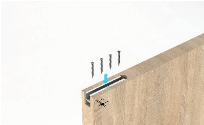
Fig. 3 : Visser l'étrier court dans le chariot côté encastrement et l'étrier long dans le chariot côté porte, en respectant une distance d'environ 15 mm.
