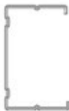
Конструкција на рамката 1 x CW 100/0,6 профил
