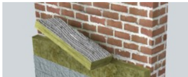
Lipirea lamelor din fibre minerale. Lipirea întregii suprafețe este susținută de utilizarea FKL Thermal
