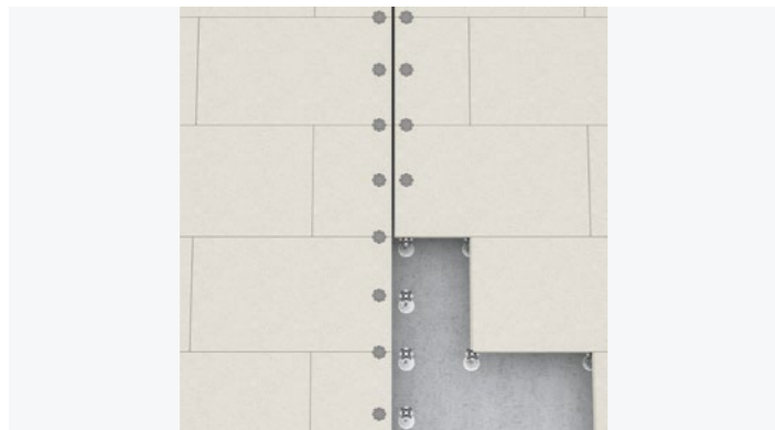
Exempel på extra stöd vid dilatationsfogar eller slitsning. Extra stöd för skivorna placeras på båda sidor av ljudfogen.
