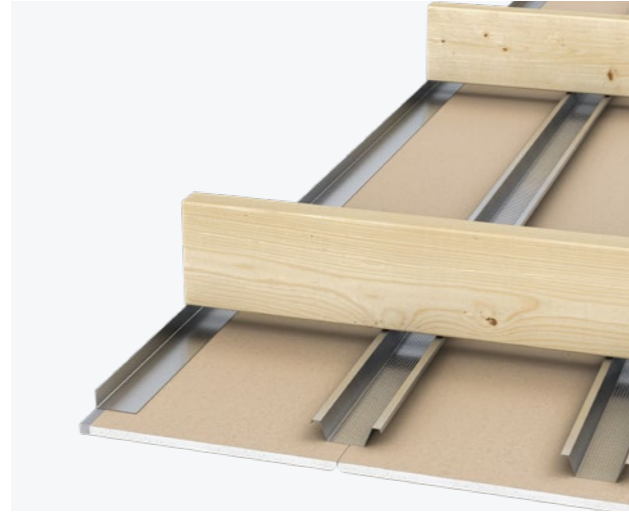
INNERTAK MED PLANK PÅ SEKUNDÄRPROFIL, LÄS MER PÅ SID 259
