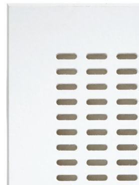
Tangent T1, 4 x 14 mm, tussenafstand 10/20 mm Perforatie: 24,5 %
