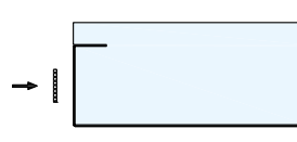
Bild 5: Aufbringen aufschäumendes Dichtungsband
