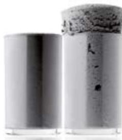
Der Sanierputz mit der patentierten, selbstaktiven Porenstruktur Popo wächst an der Wand um 30 %. 16 mm auftragen und auf 20 mm wachsen lassen. Das spart Zeit, Material und ist daher äußerst wirtschaftlich.
