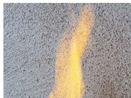
Im Kristallgefüge des Gipses sind zwei Moleküle Wasser eingelagert. Bei Brandbelastung werden sie als Kühlwasser frei. Und bei Hitzeentwicklung bildet frei werdender Wasserdampf einen feuerhemmenden Dampfschleier.
