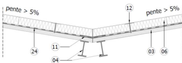
Figure 4a – Raccordement des panneaux formant écran thermique en noue - appui simple
