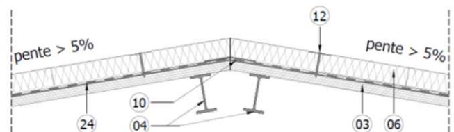
Figure 4b – Raccordement des panneaux formant écran thermique en faîtage et arêtier - appui simple
