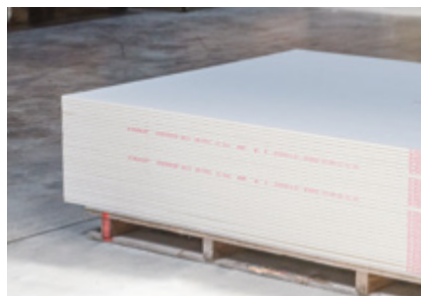
Plaques Knauf HydroProof® sur chantier
