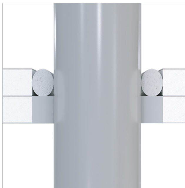
Ljudtätning kring VP-rör med fogmassa och bottningslist.
