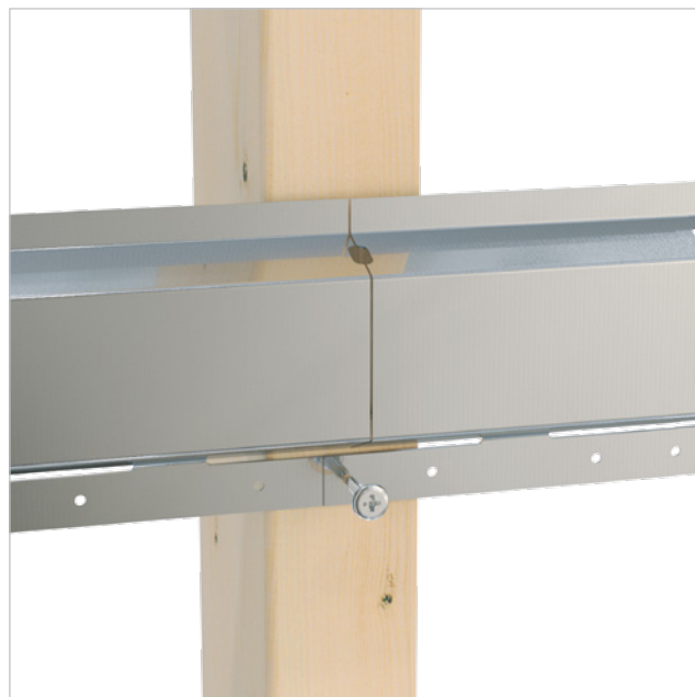
Profilerna får inte ligga omlott vid skarvning (förutom läppen) – då försämras ljudisoleringen kraftigt. Skarvning görs kant i kant och alltid över regel. Profilen fästs till stommen med montageskruv för trä i de förborrade hålen. Profilskarvarna förskjuts min. ett regel-fack i förhållande till varandra.
