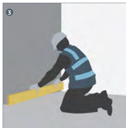
3 Montér Knauf kantstrimler ved vægtilslutninger.
