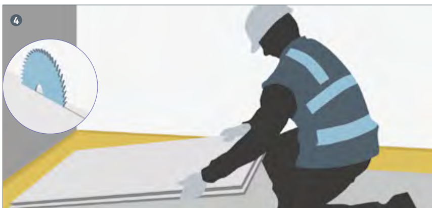
4 Når kanterne/overfalsen er skåret væk, lægges den første plade modsat døren, fra venstre mod højre. Pladerne skal være gennemgående under døre, ellers skal der installeres understøtning. Find udlægningsvejledning på side 319.
