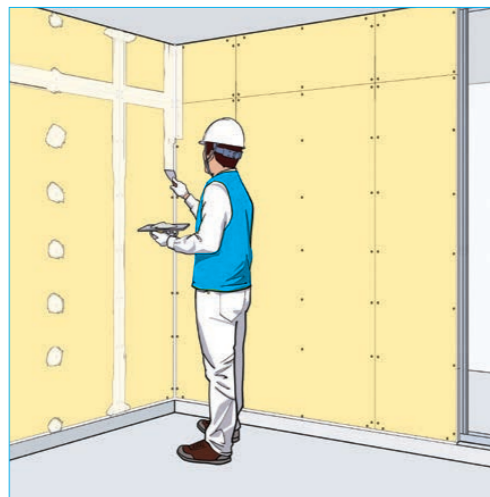
3 조인트 컴파운드 시공
