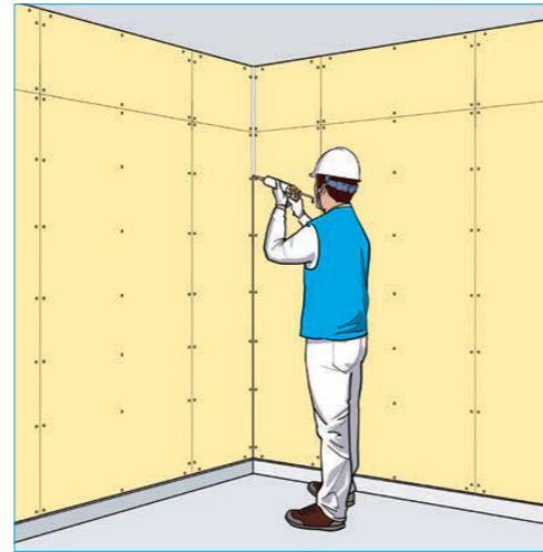
2 코너 및 접합부위 실란트 시공
