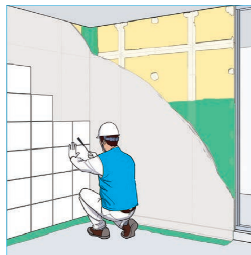
6 타일 및 타일 줄눈 시공
