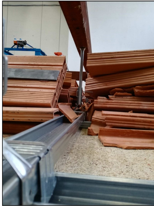
Fotografia della superficie d'estradosso dell'oggetto dopo l'urto n. 6
