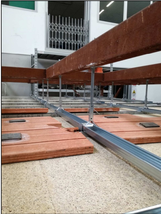
Fotografia della superficie d'estradosso dell'oggetto dopo l'urto n. 1
