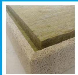
HERADESIGN® Wallcoustic Element je akustični zidni element od drvene vune vezane magnezitom te dodatno kaširan akustičnom ispunom debljine 50 mm ili 100 mm.
