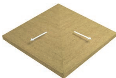
Formiranje dve krovne ravni primenom elemenata : SmartRoof Top CTF1
