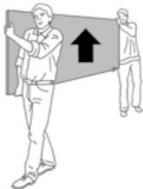
2. S'assurer de la capacité de charge du support. Une palette de plaques AQUAPANEL® Cement Board Outdoor (en état de livraison) charge le sol jusqu'à 1,2 tonne par palette.
