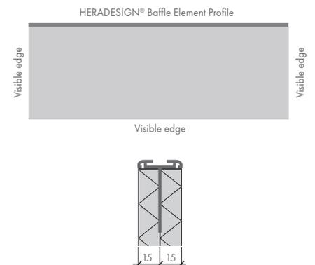
Baffle à deux couches avec un revêtement HERADESIGN® et profilé en aluminium anodisé sur le dessus.
