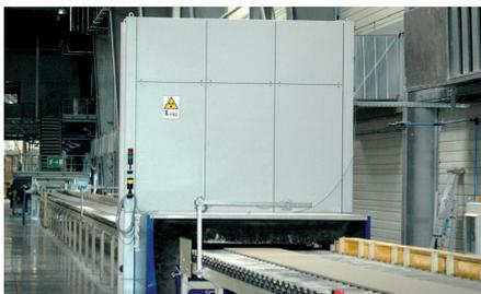
Contrôle de la production avec le scanner à rayons X
